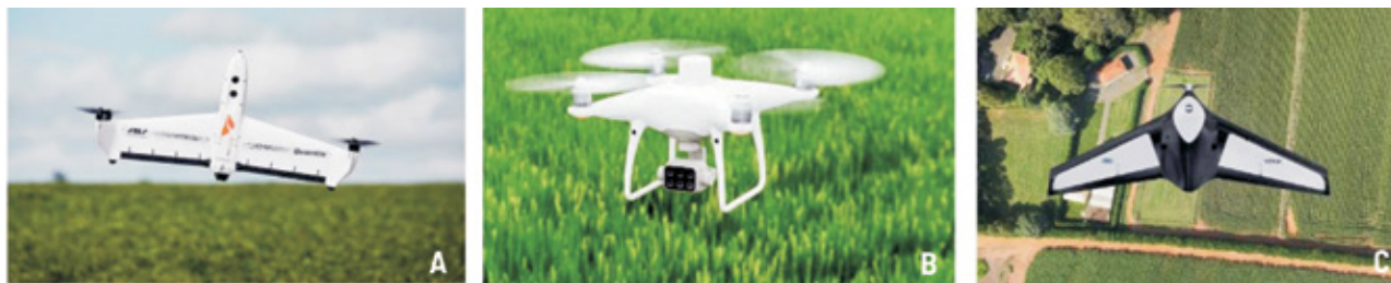
Figura 3. Tipos de Vants a) Híbrido b) Asa rotativa e c) Asa fixa
