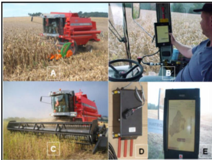
**Figura 9: (A) Colheita de milho nas áreas do projeto, (B) detalhe da cabine da MF 34 equipada com o computador de bordo, (C) colhedora realizando a colheita de soja nas áreas do projeto, (D) detalhe do sensor de rendimento Micro Track, (E) monitor Datavision de AP.**
