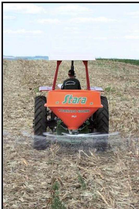
**Figura 10: Distribuidor centrífugo monodisco –Tornado 600 MD (Stara) realizando as aplicações de fertilizantes por zonas, na área de estudo com AP em pequena propriedade.**
