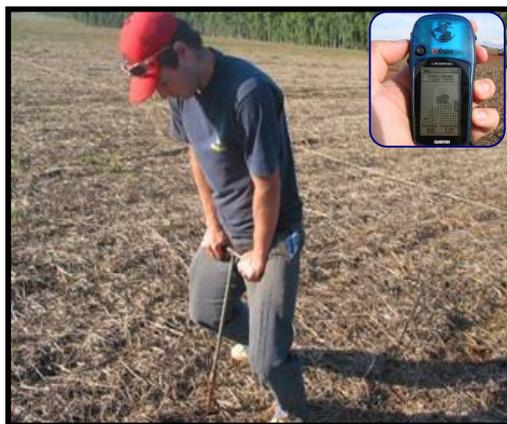
**Figura 5: Esquema do raio e forma de coleta, em detalhe o GPS de navegação para localização dos pontos e trado calador utilizado para a coleta de solo na malha de amostragem.**
