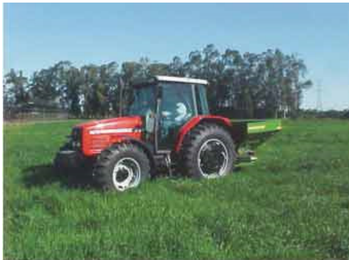
Figura 4. Trator MF 5310 equipado com Fieldstar realizando aplicação de fertilizante com o distribuidor ZAM 1500 Amazon – Stara Sfil.
