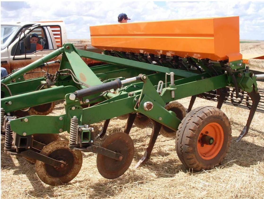
Num primeiro plano, a presença dos discos de corte, logo após as hastas escarificadoras e ao fundo o rolo destorroador. Na parte superior do chassi, encontra-se o conjunto sistema responsável pela movimentação georreferenciada do equipamento.
