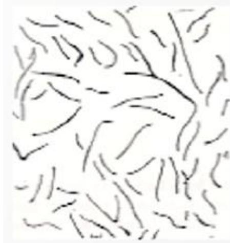
Figura 4 – Grafita lamelar do ferro fundido cinzento
