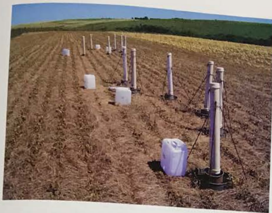
Figura 8. Detalhe dos duplos anéis concêntricos utilizados para a determinação da taxa de infiltração de água no solo.
