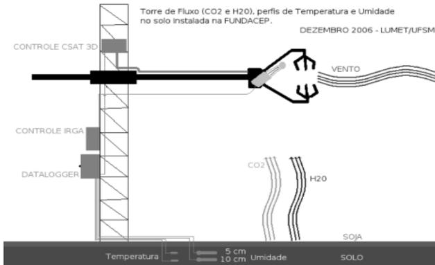
Figura 1. Ilustração da torre e instrumentos instalados.
