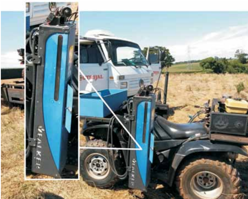
Figura 1. Conjunto de penetrômetro e quadriciclo utilizado na área experimental. Equipamento cedido pela Cooperativa Cotrijal. Não-Me-Toque, RS.
