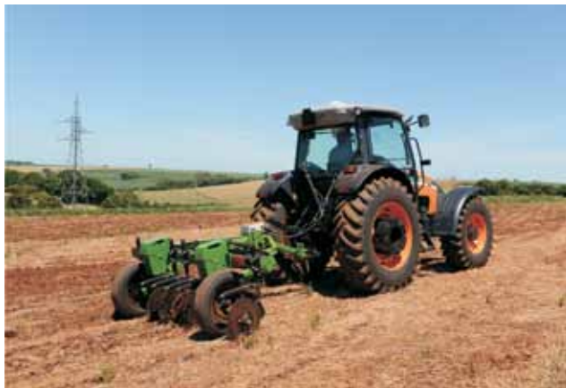
Figura 2. Equipamento Veris CE utilizado para determinação da condutividade elétrica aparente.
