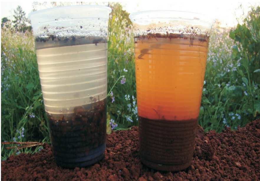
Figura 8. Presença de agregados com elevada estabilidade em área de plantio direto com culturas de cobertura (esquerda) e de baixa estabilidade em área com manejo de monocultura (direita). Santa Rosa, RS. Fonte: J. C. M. Sá (2012) cedida por A. O. Ferreira.
