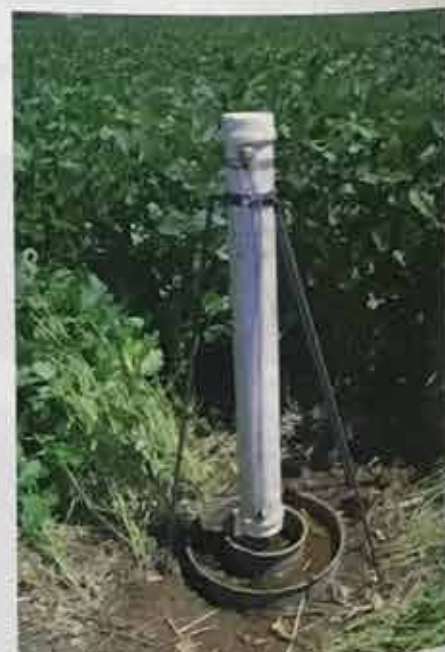
Figura 4. Equipamento medidor de infiltração de água no solo. Santa Rosa, RS. Propriedade do Sr. E. Jantsch. Foto: Sérgio Schneider, 2006.
