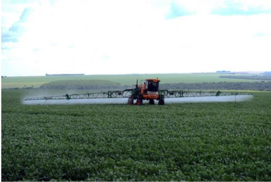
Figura 7. Pulverização precisa de agroquímicos através de pulverizador equipado com desligamento de seções.
