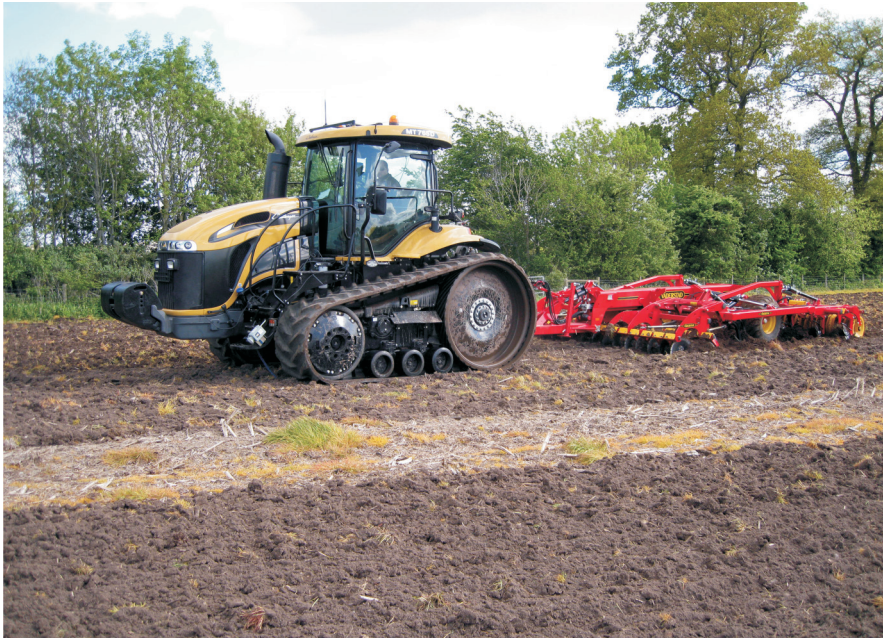
Figura 5. Trator tracionando o cultivador de solo antes da semeadura. Harper Adams University, Shropshire, Inglaterra. Foto: Girardello, 2013.
