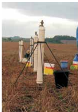
Figura 9. Determinação da infiltração de água no solo com infiltrômetros (esquerda), resultados de infiltração acumulada de água no solo durante 120 minutos (direita) com diferentes intensidades de tráfego de máquinas agrícolas. Fonte: Projeto Aquarius, 2011.
