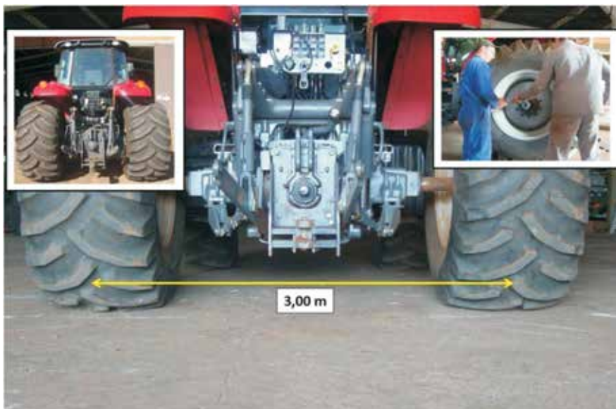
Figura 1. Determinação da bitola do rodado trazeiro do trator para estabelecimento de linhas de tráfego.
