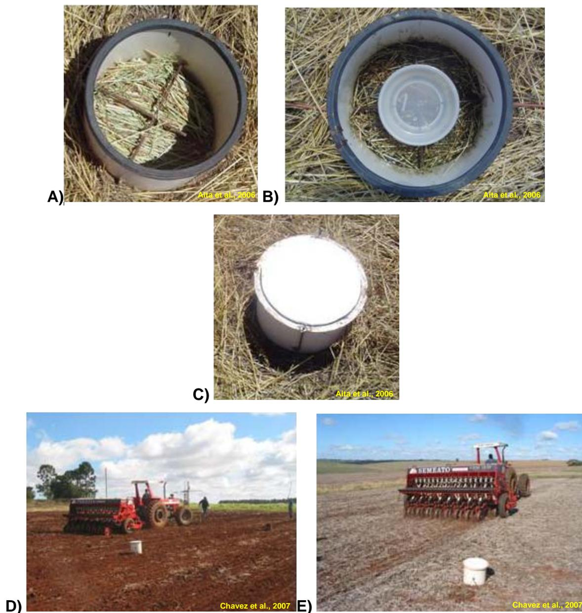
Figura 2 - Câmara estática (câmara de PVC) para medição da evolução de C-CO<sub>2</sub> a campo; a) câmara aberta com armação de ferro; b) câmara com recipiente contendo a solução de NaOH; c) câmara fechada por quatro parafusos; d) câmara instalada em PC; e) câmara instalada em PD.
