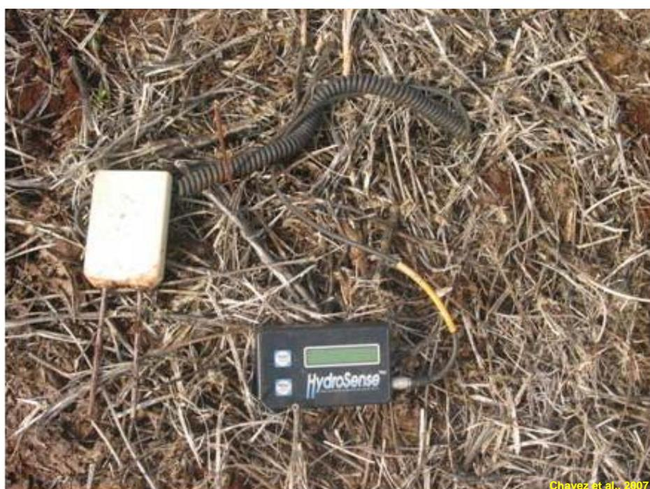
Figura 5 - Sistema portátil (TDR) utilizado para medição da umidade do solo.
