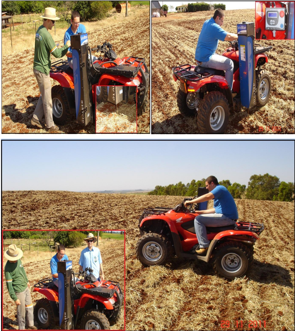
Figura 4 – Procedimentos realizados para a coleta de informações de resistência à penetração a partir do penetrômetro SoloStar da empresa Falker.
