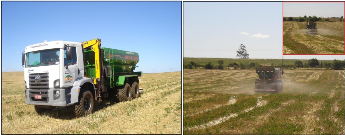
Figura 3 – Equipamento utilizado para a aplicação à taxa variada dos corretivos e fertilizantes.
