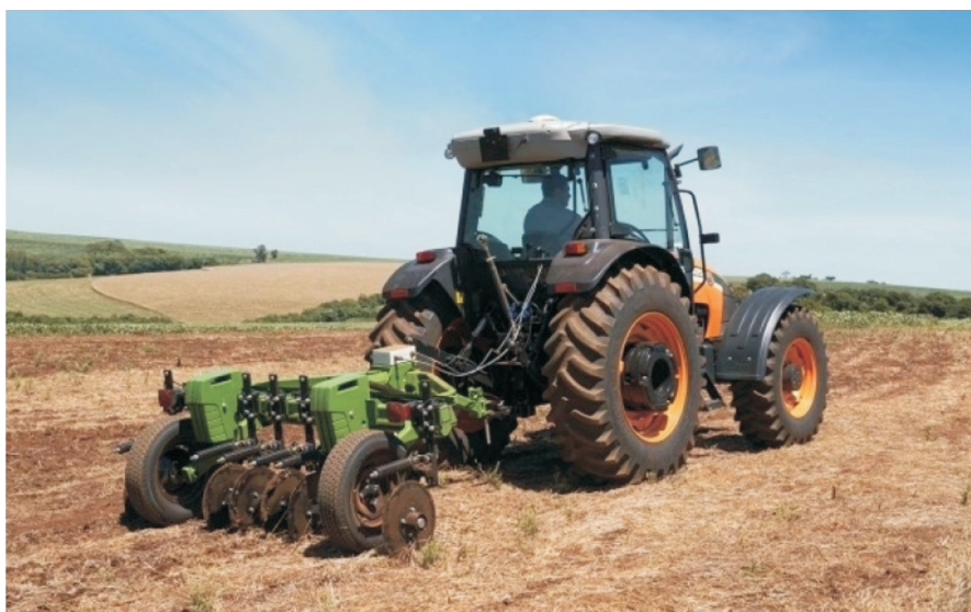
Figura 2. Sensor de condutividade elétrica do solo utilizado na área agrícola de Carazinho, RS.
