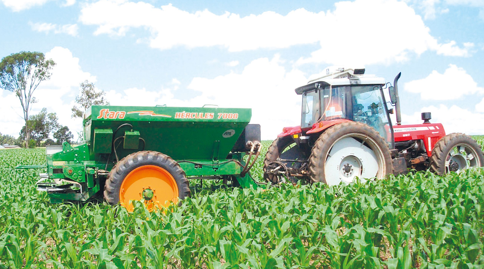
Figura 43. Aplicação de Nitrogênio à taxa variada em tempo real com YaraBela e Yara N-Sensor®. Fonte: Projeto Aquarius
