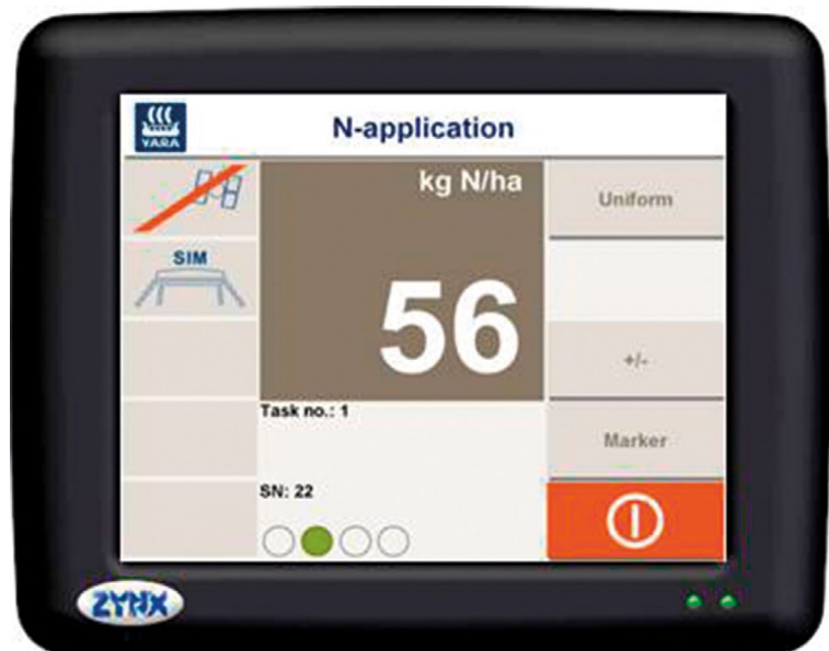
Figura 44. Exemplo de um monitor com informação da dose de aplicação de Nitrogênio calculada através da leitura do Índice de Vigor de Biomassa (IVB), em tempo real, fornecida pelo Yara N-Sensor®, da Yara, em um dos experimentos do Projeto Aquarius. Fonte: Projeto Aquarius.
