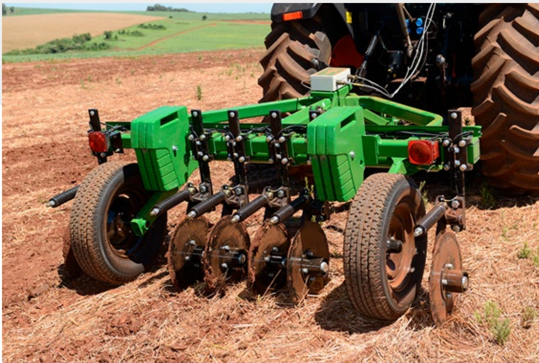
Figura 66. Equipamento Veris utilizado para medir a condutividade elétrica do solo. Fonte: Stara.
