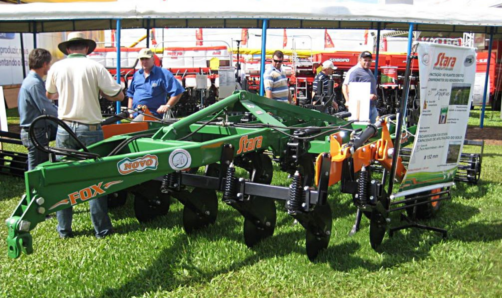
Figura 31. O Fox é o primeiro escarificador para plantio direto utilizado no Brasil. Fonte: Projeto Aquarius.
