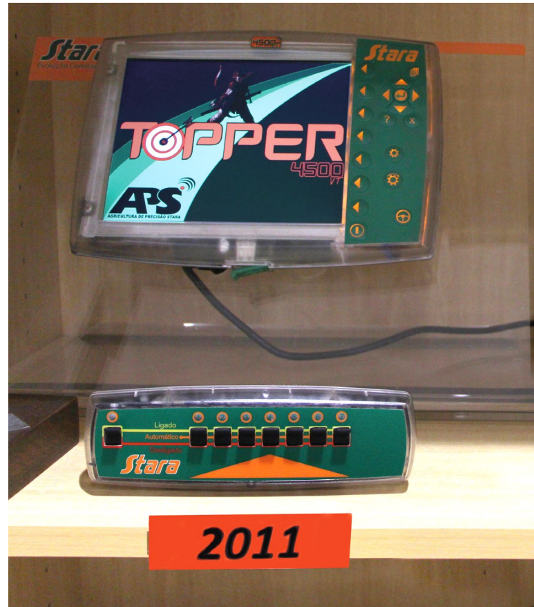
Figura 60. Topper 4500, controlador de vazão, DGPS, Desligamento Automático de Seções e Piloto Automático. Fonte: Projeto Aquarius.
