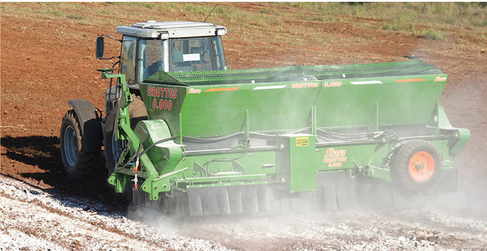
Figura 36. Distribuidor Bruttus sendo utilizado, visando garantir a qualidade da distribuição de produtos em pó. Fonte: Projeto Aquarius.
