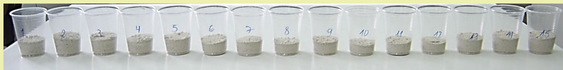
Figura 35. Perfil de distribuição de Calcário adotando os requisitos de Agricultura de Precisão. Fonte: Cotrial - Projeto Ciclus
