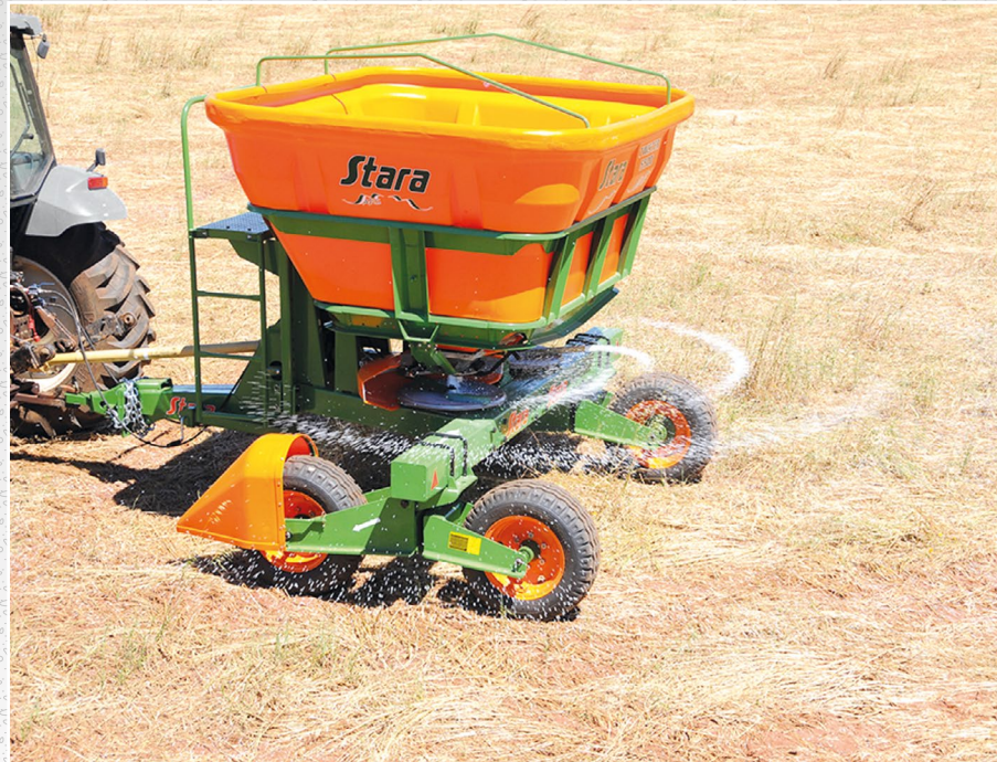
Figura 12. Distribuidor Twister utilizado para fertilização à taxa variada em 2005. Fonte: Stara.
