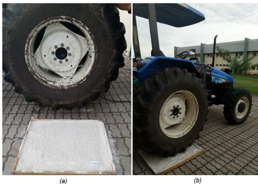
Figura 2 – seqüência da metodologia adotada para análise; forma preenchida e nivelada com cal (a), formação da área de contato com o peso do trator sobre a forma (b).
