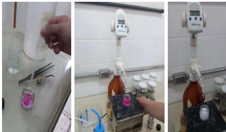
Figura 2: Aplicação do método de titulometria para determinar a quantidade de C-CO 2 liberado.
