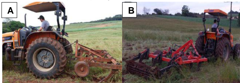
Legenda: A) Subsolador convencional. B) Subsolador dotado de disco de corte e rolo destorroador.
