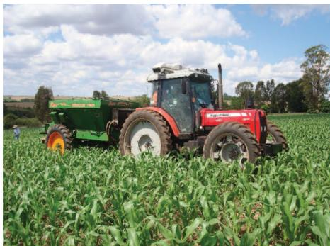
**Figura 1.** Trator MF 297 equipado com N-sensor distribuidor Hercules 7000.
